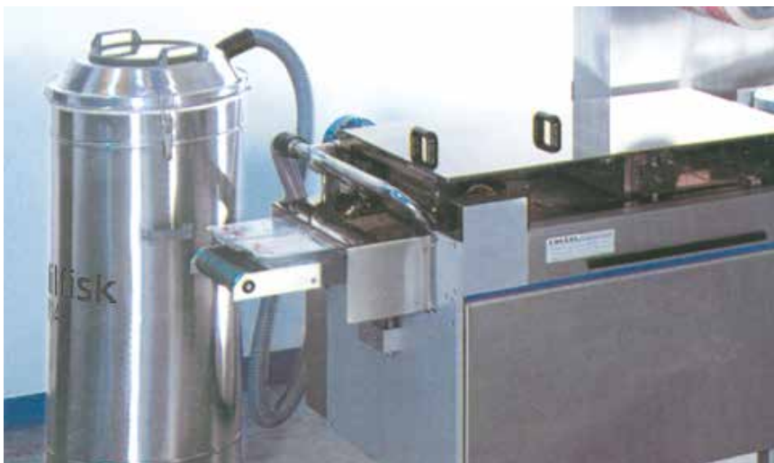
Usuwanie ścinków z maszyny pakującej
